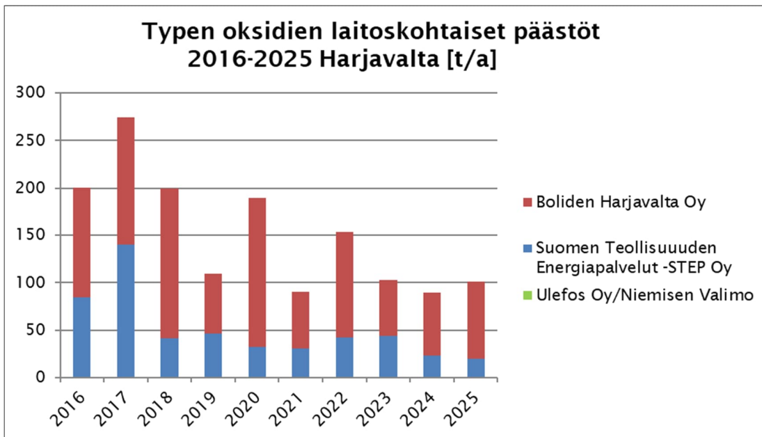
Kuvio 43. Typen oksidien laitoskohtaiset päästöt Harjavallassa vuosina 2016–2025. Ulefos Oy/Niemisen Valimon typen oksidien päästöt ovat niin pienet (vuonna 2025 0,4 t), etteivät ne näy erikseen kuviossa. Typen oksidien kokonaispäästömäärä on vaihdellut viime vuosina välillä 90-100 t/vuosi.
