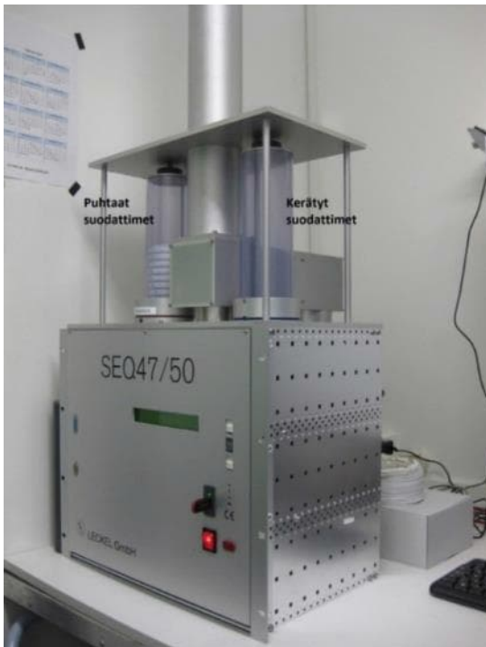
Kuva 4. Harjavallan Kalevan ja Pirkkalan mittausasemilla on standardin EN 12341:2014 vaatimukset täyttävät Leckel SEQ 47/50-hiukaskeräimet PM_{10} -metallinäytteiden keruuta varten. Laite kerää vuorokausinäytteen siten, että keräyspäiviä on kalenterivuodessa 183 kpl/mittausasema. Suodattimet analysoidaan KVVY Tutkimus Oy:n laboratoriossa Tampereella standardin SFS-EN 14902:2006 mukaisesti.
