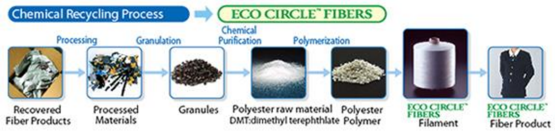
Kuva 2. Teijinin EcoCircle materiaalin kemiallisen kierrätyksen prosessi. (Teijin Frontier Co Ltd www-sivut, 2018).
